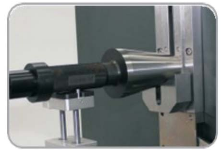
Измерение гладкой конусной калибр-пробки
