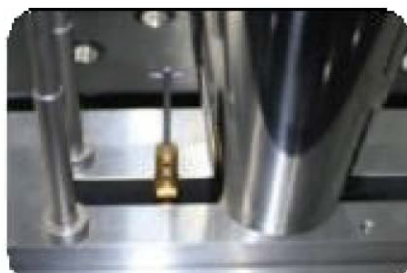
Измерение гладкой конусной калибр-пробки
