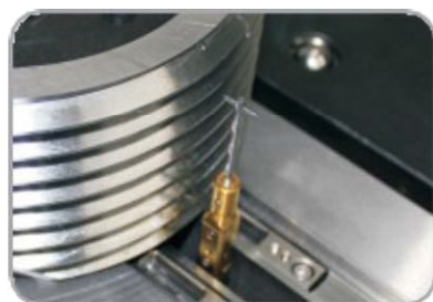
Измерение гладкой калибр-пробки
