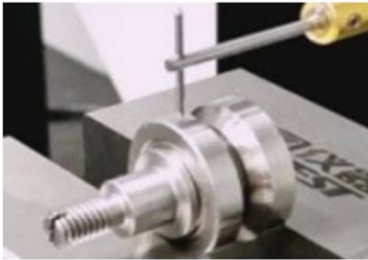
Измерение профиля детали
