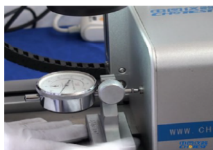
Проверка индикатора часового типа
