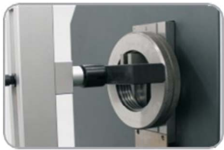
Измерение резьбового калибр-кольца
