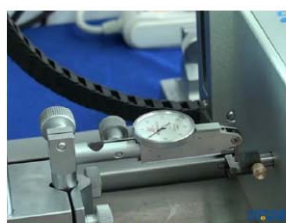
Проверка индикатора рычажного
