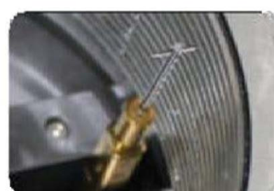
Измерение резьбового калибр-кольца
